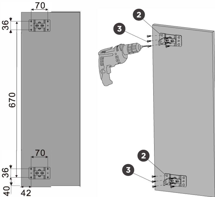
**2.2** Positionner les attaches dans le cadre et verrouiller avec les vis
